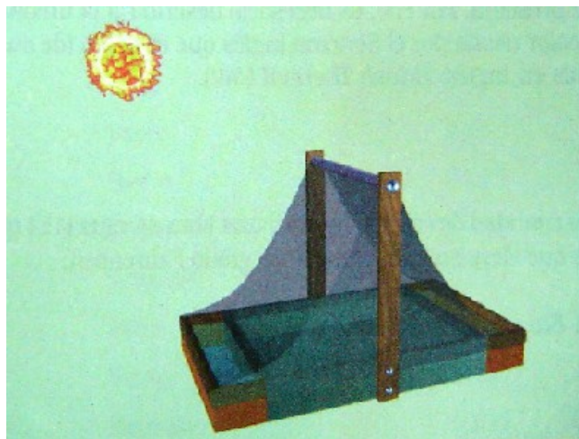
Fig. 4 En los destiladores solares se utiliza la energía calorífica proveniente del Sol, para obtener agua potable a partir del agua salada de los mares.
